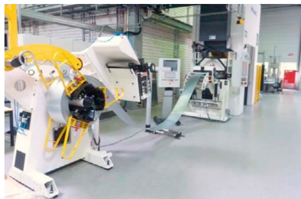
Neuanschaffungen im IFUM (s. S. 79): Bandanlage und 3D-Transfersystem der Firma Helmerding integriert in Umformmaschine der Firma Schuler. Foto: IFUM
