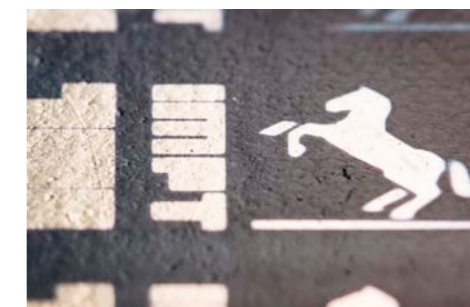
Entscheidende Grundlage für den Sensor: die dünnfilmtechnische Goldbeschichtung auf Gummi.
